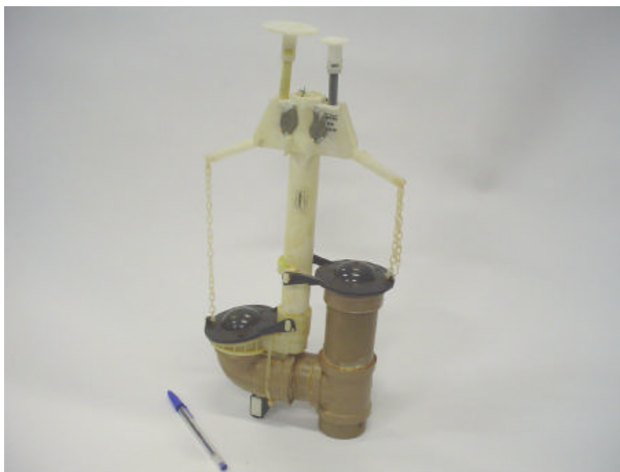
Foto 6: O protótipo P3 montado fora da caixa acoplada.
